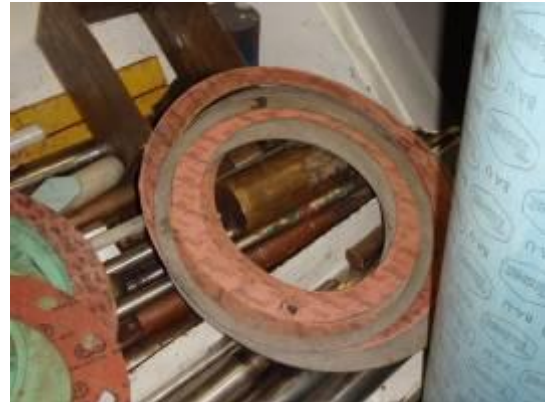
foto 2: asbesthoudende pakkingmateriaal / asbesthoudende pakkingen tussen flenzen.
